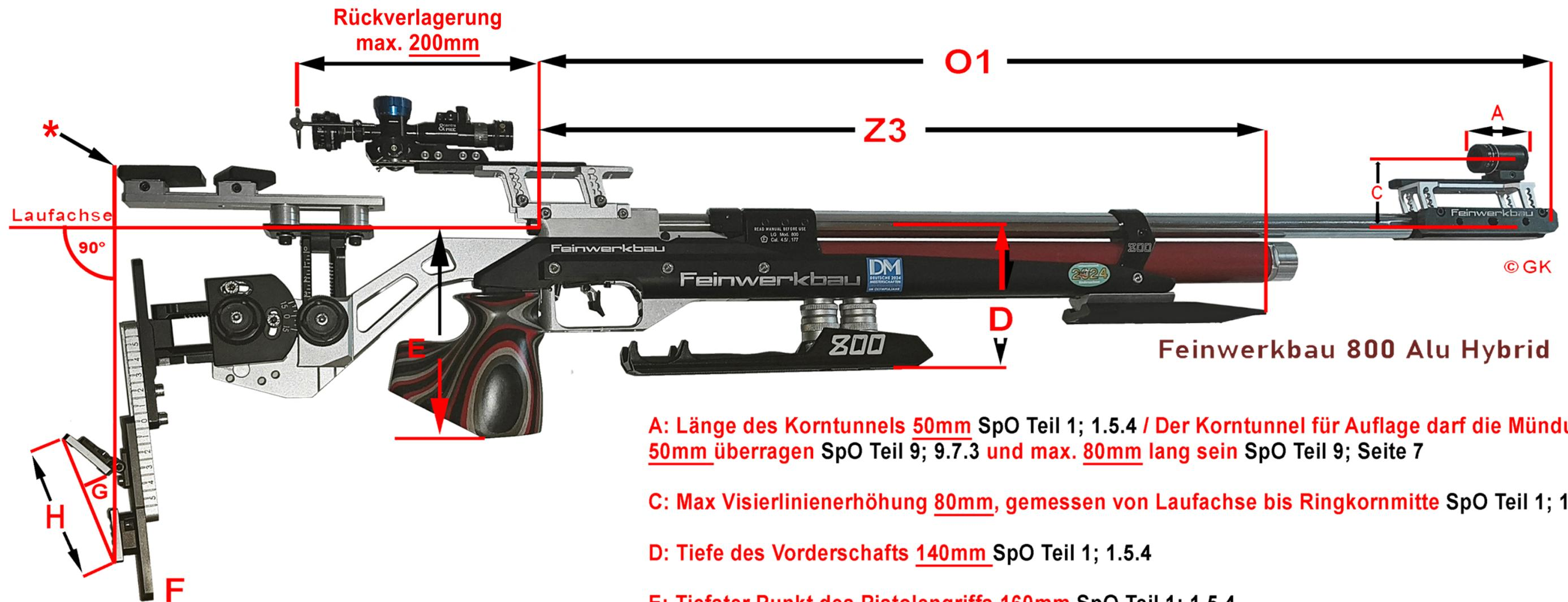
**A:** Länge des Korntunnels 50mm SpO Teil 1; 1.5.4 / Der Korntunnel für Auflage darf die Mündung 50mm überragen SpO Teil 9; 9.7.3 und max. 80mm lang sein SpO Teil 9; Seite 7
